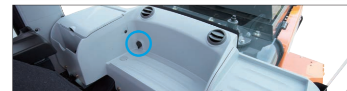
DC12V 電源ユニット NEW シート後ろの大容量ユーティリティスペース
